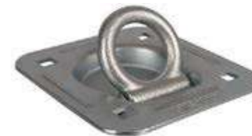
37603 Placa Amarre Galva c/ anilla 1135/2270kg 114x124mm La placa de dimensiones 124 x 114 x 3 mm • Paso M10 • tamaño de los ojete 55 x 10 mm • resistencia a la tracción 2270 kg, una carga máxima a la tracción. autorizado de 1 135kg
